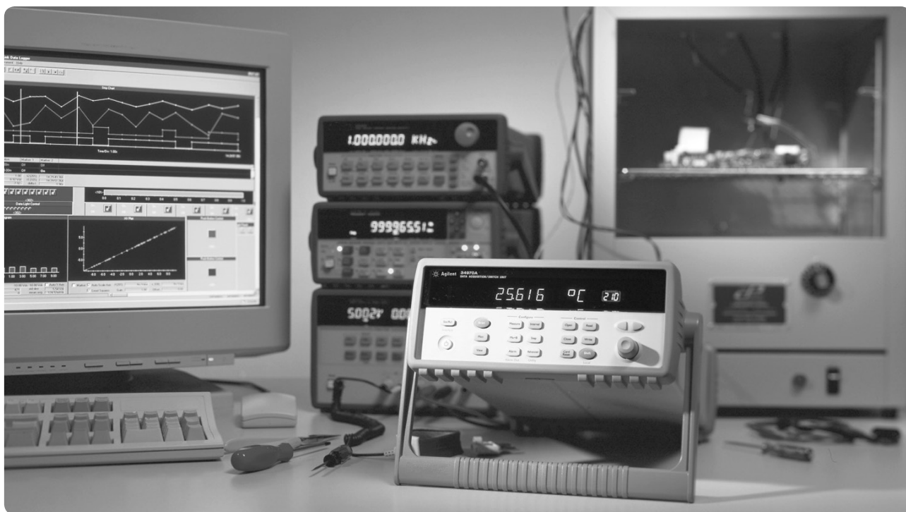
Système compact d'acquisition de données 60 voies
