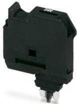
保险丝插头，更换G型保险丝前，先从底座端子上拆下保险丝插头。, 标称工作电压: 500 V, 额定电流: 6.3 A, 接线方式: 直插式连接, 保险丝类型: G / 5 x 20, 颜色: 黑色
