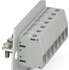
嵌板穿通接线柱块，接线方式: 带压片的螺钉连接，电缆端头，位数: 1，负载电流: 150 A，横截面: 16 mm<sup>2</sup> - 50 mm<sup>2</sup>，导线连接方向与拔插方向的夹角: 0 °，宽度: 18.8 mm，颜色: 绿黄相间
