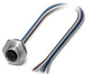
センサ/アクチュエータ筐体取付けソケット、5極、M12、Aコーディング、M20 x 1.5ねじで前面/ねじ取付け、0.5 mのTPEばら線付き、0.34 mm<sup>2</sup> x 5、真鍮製
