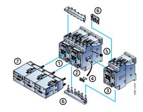
Grandezze costruttive S0-S0-S0 fino a 22 kW esecuzione con collegamento a vite
