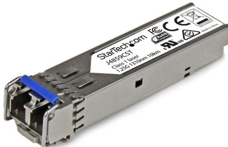
Das J4859CST ist ein HP J4859C-kompatibles Glasfaser-Transceiver-Modul, das speziell für die Zusammenarbeit mit HP®-Switches und -Router entwickelt, programmiert und getestet wurde. Es liefert zuverlässige 1-GbE-Konnektivität über Glasfaserkabel für 1000BASE-LX-konforme Netzwerke mit einer maximalen Entfernung von bis zu 10 km.
