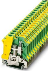
接地端子，连接量: 2，接线方式: 螺钉连接，横截面: 0.2 mm<sup>2</sup> - 10 mm<sup>2</sup>，安装方式: PE支脚及安装螺钉，M4，安装方式: NS 35/7,5，NS 35/15，NS 32，颜色: 黄绿相间
