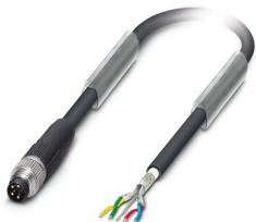
Câble préconfectionné pour bus, INTERBUS, 4-pôles, PUR exempt d'halogène, noir RAL 9005, blindé, connecteur mâle droit M8, sur extrémité libre, longueur de câble: 10 m
