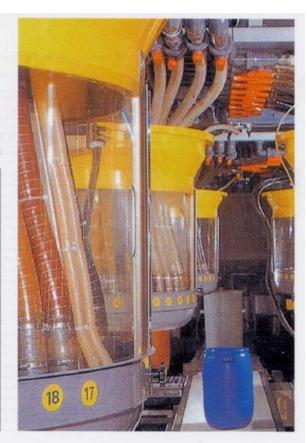
Molto flessibile, robusto, resistente all'abrasione, interno ed esterno lisci. Temperatura: -5° C +65° C.
