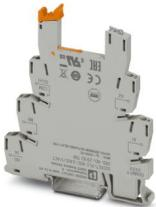
6,2 mm PLC-Grundklemme für Ausgabefunktionen mit Schraubanschluss, ohne Relais- oder Solid-State-Relaisbestückung, zur Montage auf Tragschiene NS 35/7,5, mit Lastrückleiteranschluss (BB), 1 Schließer, Eingangsspannung 24 V AC/DC
