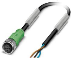
センサ/アクチュエータケーブル、3-極、PUR ハロゲンフリー、黒-灰RAL 7021、片側フリー、上 メス ストレート M12、キーイング: A、ケーブル長: 1.5 m
