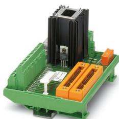
16-kanaliges Digital-Ausgabemodul mit Schraubanschluss und redundanter Spannungseinspeisung. Geeignet für die Yokogawa-Karte SDV 541.
