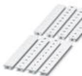
Repérage ZB, Rubans, blanc, repéré, repérable avec : Traceur, impression longitudinale: numérotation continue 1-10, 11-20, etc. jusqu'à 491-500, Type de montage: Encliquetage dans la rainure de repérage élevée, pour BJ au pas de : 8,2 mm, Surface utile: 10,5 x 8,15 mm
