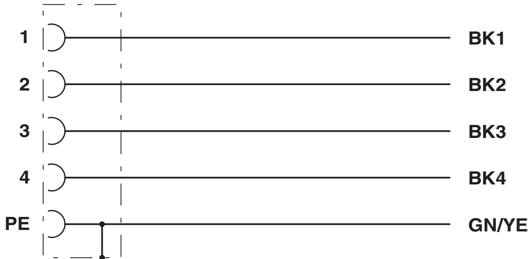
Kontaktbelegung der M12-Buchse
