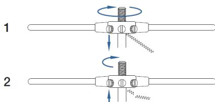
Le filiere HSS sono idonee alle lavorazioni di tutti i metalli e gli acciai in genere con  $R<800 \text{ N/mm}^2$ . E' buona norma, ad ogni rotazione del girafiliere (1), effettuare mezzo giro in senso antiorario per rompere il truciolo generato ed ottenere una ottima finitura superficiale del filetto.
