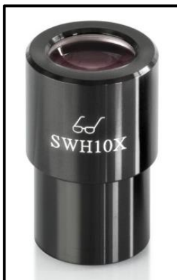
High Eye Point Okular (erkenntlich am Brillen-Symbol)
