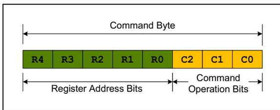
**FIGURE 6-5: I<sup>2</sup>C Command Byte Format.**
