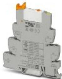
PLC-INTERFACE, composé d'un module de base PLC-BSC.../21 à raccordement vissé et d'un relais miniature enfichable à contact doré multicouches et actionnement manuel, 1 contact inverseur, tension d'entrée 230 V AC/220 V DC
