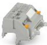
Adaptateur V8 pour 8 x PLC-INTERFACE (6,2 mm), automate: Câblage système API des cartes d'entrée, raccordement 1: Raccordement vissé 1x, raccordement 2: IDC/FLK connecteur mâle 1x 14-pôles, raccordement 3: Raccordement enfichable (Encliquetable sur les 8x blocs de jonction PLC-INTERFACE), nombre de canaux: 8, logique de commande: à commutation +
