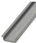
Profilé plein, Profil standard, largeur: 35 mm, hauteur: 7,5 mm, selon EN 60715, matériau: Acier inoxydable V2A, aucun revêtement, longueur: 2000 mm, coloris: argenté
