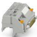
Adaptateur V8 pour 8 x PLC-INTERFACE (6,2 mm), automate: Câblage système API des cartes d'entrée, raccordement 1: Raccordement vissé 1x, raccordement 2: Connecteur mâle D-SUB 1x 15-pôles, raccordement 3: Raccordement enfichable (Encliquetable sur les 8x blocs de jonction PLC-INTERFACE), nombre de canaux: 8, logique de commande: à commutation +
