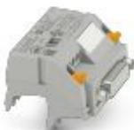
Adaptateur V8 pour 8 x PLC-INTERFACE (6,2 mm), automate: Câblage système API des cartes d'entrée, raccordement 1: Raccordement vissé 1x, raccordement 2: Connecteur femelle D-SUB 1x 15-pôles, raccordement 3: Raccordement enfichable (Encliquetable sur les 8x blocs de jonction PLC-INTERFACE), nombre de canaux: 8, logique de commande: à commutation +
