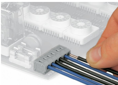
Raccordement d'un conducteur par insertion directe
