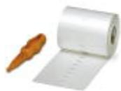
Repères pour blocs de jonction, Rouleau, blanc, vierge, repérable avec : THERMOMARK ROLL, THERMOMARK ROLL X1, THERMOMARK X, THERMOMARK S1.1, perforé, Type de montage: Encliquetage dans la rainure de repérage universelle, Encliquetage dans la rainure de repérage plate, pour BJ au pas de : 6,2 mm, Surface utile: 6,35 x 6,15 mm
