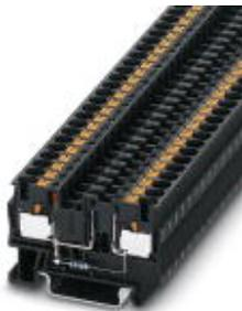
BJ-fusibles, Type de raccordement: Raccordement Push-in, section :0,2 mm<sup>2</sup>- 6 mm<sup>2</sup>, AWG: 24 - 10, Intensité nominale: 10 A, Tension nominale: 12 V, Largeur: 6,2 mm, Type de fusible: Type F (miniature), Type de fusible: Plat, Type de montage: NS 35/7,5, NS 35/15, Coloris: noir
