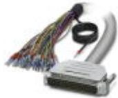
Cavo circolare confezionato schermato; collegamento 1: Fili singoli (37-poli) (I conduttori sono siglati e dotati di capocorda. La treccia schermata è prevista su un'estremità separata del cavo.); collegamento 2: Connettore maschio D-SUB (1x 37-poli); lunghezza cavo: variabile
