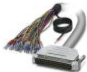
Cavo circolare confezionato schermato; collegamento 1: Fili singoli (37-poli) (I conduttori sono siglati e dotati di capocorda. La treccia schermata è prevista su un'estremità separata del cavo.); collegamento 2: Connettore maschio D-SUB (1x 37-poli); lunghezza cavo: 6 m
