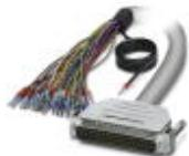
Cavo circolare confezionato schermato; collegamento 1: Fili singoli (37-poli) (I conduttori sono siglati e dotati di capocorda. La treccia schermata è prevista su un'estremità separata del cavo.); collegamento 2: Connettore maschio D-SUB (1x 37-poli); lunghezza cavo: 3 m
