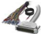
Cavo circolare confezionato schermato; collegamento 1: Fili singoli (37-poli) (I conduttori sono siglati e dotati di capocorda. La treccia schermata è prevista su un'estremità separata del cavo.); collegamento 2: Connettore maschio D-SUB (1x 37-poli); lunghezza cavo: 4 m
