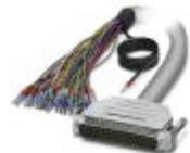
Cavo circolare confezionato schermato; collegamento 1: Fili singoli (37-poli) (I conduttori sono siglati e dotati di capocorda. La treccia schermata è prevista su un'estremità separata del cavo.); collegamento 2: Connettore maschio D-SUB (1x 37-poli); lunghezza cavo: 1,5 m
