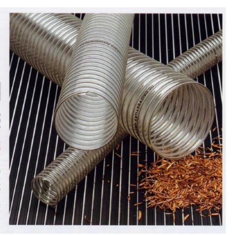
Tubo molto flessibile, superficie interna liscia. Alta resistenza all'abrasione, alla trazione e alla rottura, agli oli e benzine, alle soluzioni alcaline diluite e agli acidi, ai raggi U.V. e agli agenti atmosferici. Temperatura d'utilizzo -40°C +90°C per breve tempo fino a 125°C.
