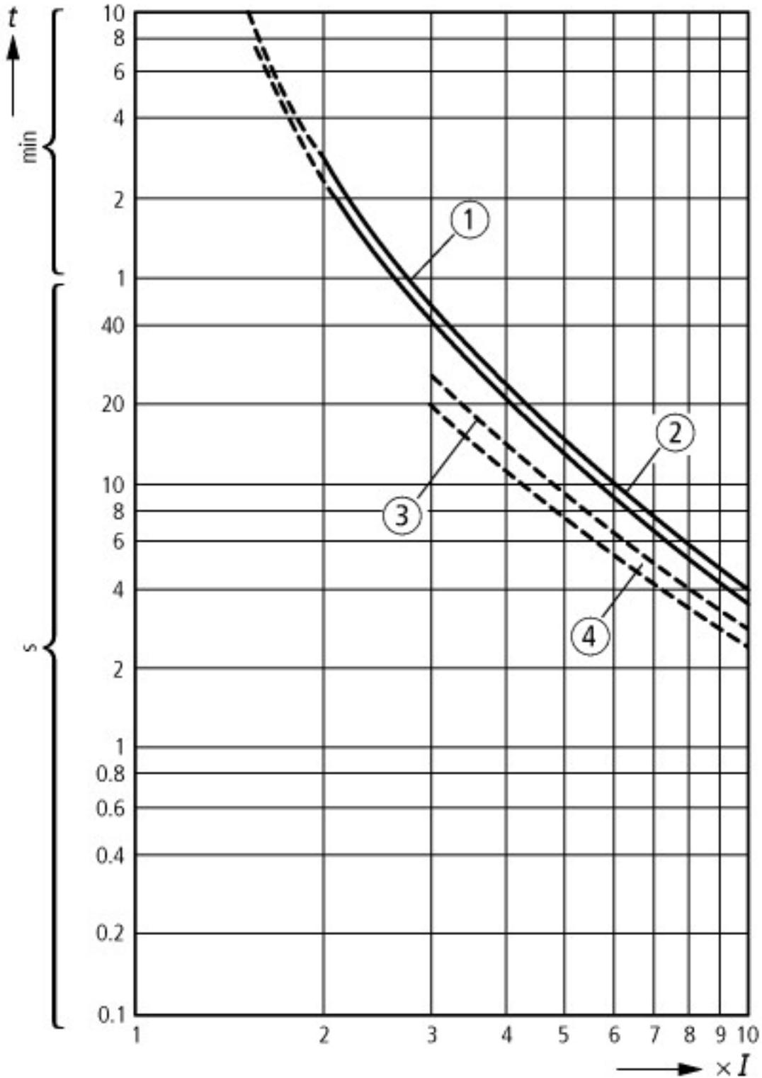
Diese Auslösekennlinien sind Mittelwerte der Streubänder bei 20 °C Umgebungstemperatur vom kalten Zustand aus. Auslösezeit in Abhängigkeit vom Ansprechstrom. Bei betriebswarmen Geräten sinkt die Auslösezeit der Motorschutzrelais auf ca. 25 % des abgelesenen Wertes. Spezifische Kennlinien für jeden einzelnen Einstellbereich im Handbuch
