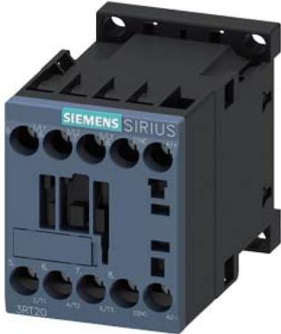
Leistungsschütz, AC-3e/AC-3, 9 A, 4 kW / 400 V, 3-polig, DC 24 V, 0,7-1,25\* Us, mit integrierter Supressordiode, Hilfskontakte: 1 Ö, Schraubanschluss, Baugröße: S00, geeignet für SPS-Ausgänge, nicht mit Hilfsschalter erweiterbar
