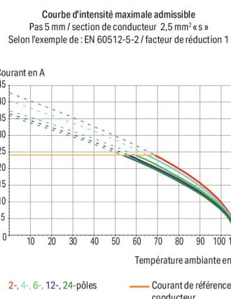
Borne pour circuits imprimés série 236 avec introduction du conducteur vers la platine de 45 °
