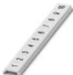
Repérage ZB, plat, Rubans, blanc, repéré, impression longitudinale: numérotation continue 1 ... 10, 11 ... 20, etc. jusqu'à 491 ... 500, type de montage: encliquetage dans la rainure de repérage plate, pour bloc de jonction au pas de : 5 mm, surface utile: 5,15 x 5,15 mm
