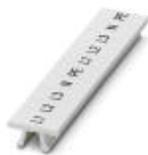
Repérage ZB, Rubans, blanc, repéré, longitudinal: L1, L2, L3, N, PE, L1, L2, L3, N, PE, type de montage: encliquetage dans la rainure de repérage élevée, pour bloc de jonction au pas de : 5,2 mm, surface utile: 5,15 x 10,5 mm
