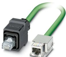
Konfektioniertes PROFINET-Kabel, CAT 5e, geschirmt, Sternvierer, AWG 22 flexibel (7-drähtig), RAL 6018 (gelbgrün), RJ45-Buchsenmodul/IP20 für Freenet-System, 4-polig auf RJ45-Stecker/IP67 Push-Pull Kunststoffgehäuse, Line, Länge: 2 m
