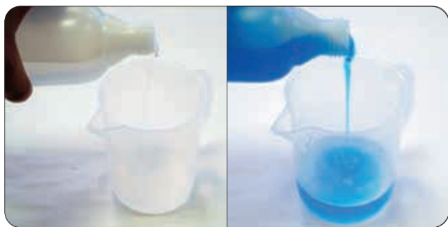
1. Pour the components 1:1 in a becker 1. Les 2 composants sont coulés dans un verre dans un rapport 1:1
