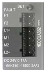
Bild 4-3 Spannungsversorgung SCALANCE X101-1
