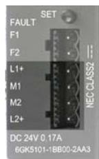
Bild 4-21 Spannungsversorgung SCALANCE X101-1POF
