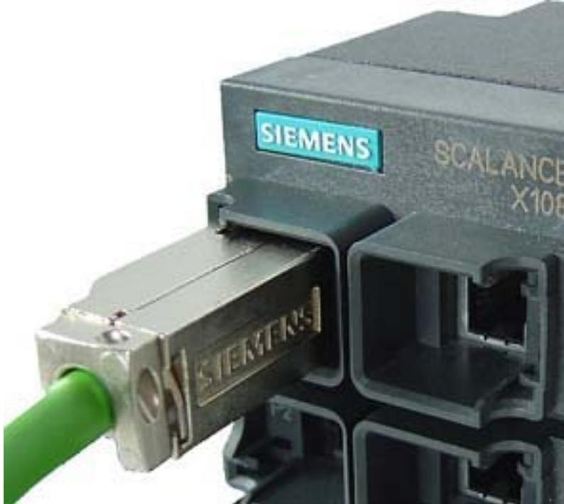
Bild 5-5 Stecken des IE FC RJ45 Plug 180
