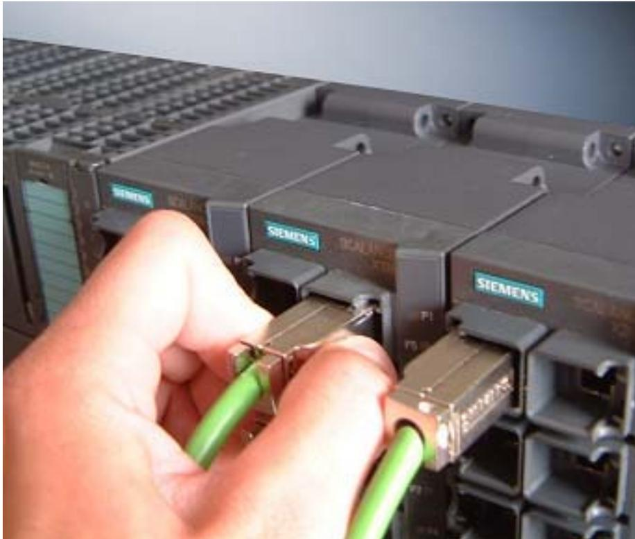
Bild 5-6 Entriegelung des RJ45 Plug
