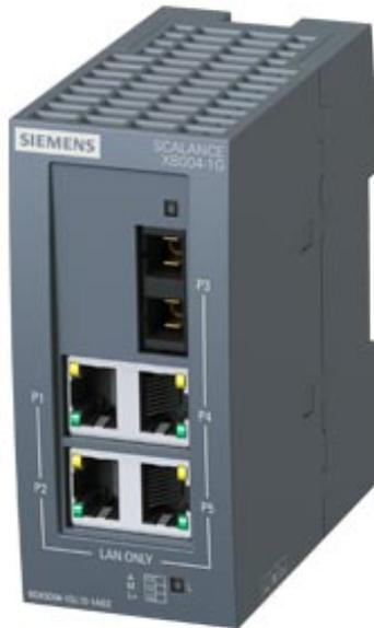
SCALANCE XB004-1G unmanaged Industrial Ethernet Switch für 10/100/1000 Mbit/s; zum Aufbau von kleinen Stern- und Linienstrukturen; LED-Diagnose, IP20, DC 24V Spannungsversorgung, mit 4x 10/100/1000 Mbit/s RJ45 Ports elektrisch und 1 x 1000 Mbit/s SC-Port optisch (Multimode, Glas), bis max. 750 m Handbuch als Download verfügbar
