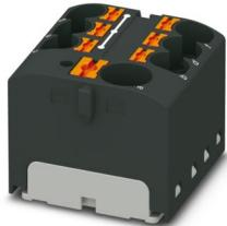
接线板，标称工作电压: 450 V，额定电流: 41 A，连接量: 7，接线方式: 直插式连接，负载触点，额定接线容量: 4 mm<sup>2</sup>，横截面: 0.2 mm<sup>2</sup> - 6 mm<sup>2</sup>，直插式连接，线路触点，额定接线容量: 10 mm<sup>2</sup>，横截面: 0.5 mm<sup>2</sup> - 10 mm<sup>2</sup>，安装方式: 用于卡接在DIN导轨适配器上，直接安装，带法兰，自由悬挂，颜色: 黑色
