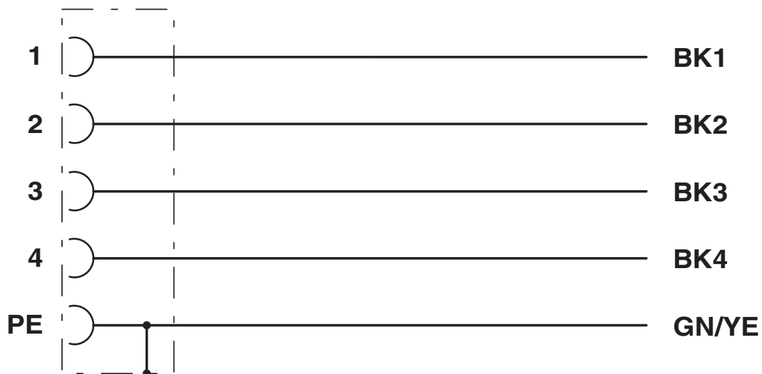
Kontaktbelegung der M12-Buchse
