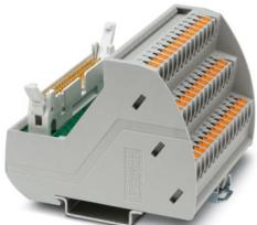
VARIOFACE-Modul, mit Push-in-Anschluss und Flachbandkabel-Steckverbinder, zur Montage auf NS 35-Tragschienen, mit Stiftleiste sowie kurzen und langen Verriegelungsbügeln für Buchsenleisten, Polzahl: 40
