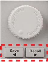
通过旋钮下面的 "保存" 和 "调用" 键, 您能立即将所有的测试设置参数保存/调用到五个可用存储缓冲器之一, 也可以保存/调用缓冲器中的设置参数。
