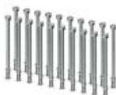
オプションの取付けねじ、ローレットなしで狭い場所に取付け可能、マイナスねじ、長さ：40 mm、UNC 4-40ねじ、標準納品は1袋20個
