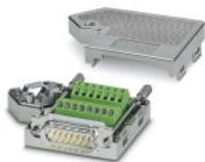
D-SUBコネクタ、15極、オスコネクタ、ケーブル挿入口×1 (挿入角は35度以下)、すべてのシステムに対応する汎用タイプ、ピン割当て：1、2、3、...、14、15、ネジ接続式端子台
