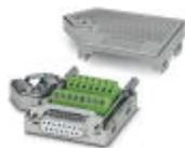
D-SUBコネクタ、15極、メスコネクタ、ケーブル挿入口×1 (挿入角は35度以下)、すべてのシステムに対応する汎用タイプ、ピン割当て：1、2、3、...、14、15、ネジ接続式端子台
