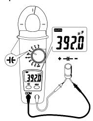
Hinweis: Zur Verbesserung der Messgenauigkeit bei kleinen Kondensatoren notieren Sie den Wert bei nicht angeschlossenen Messleitungen; subtrahieren Sie anschließend die Restkapazität des Geräts und der Leitungen von der abschließenden Messung.
