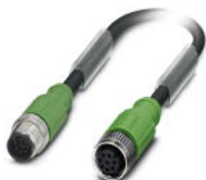
センサ/アクチュエータケーブル, 8-極, PUR ハロゲンフリー, 黒-灰RAL 7021, シールド対応, プラグ ストレー ト M12, Aコーディング, 上 ソケット ストレー ト M12, Aコーディング, ケーブル長: 0.3 m
