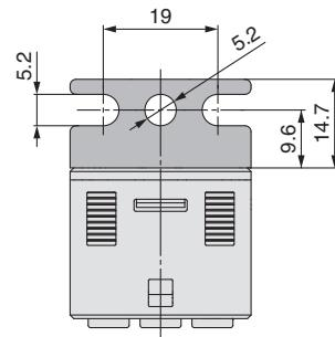
\* La configurazione del supporto consente un montaggio in quattro direzioni.
