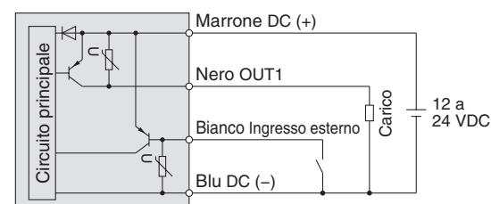
Max. corrente di carico: 80 mA, caduta di tensione interna: 1.5 V max.
