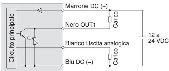
Max. tensione applicata: 28 V, Max. corrente di carico: 80 mA, caduta di tensione interna: 1 V max.
