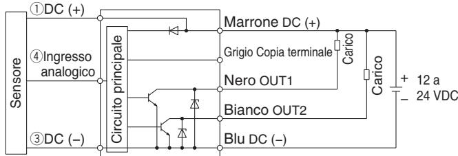
**-RT: NPN (2 uscite) + Uscita analogica in tensione
