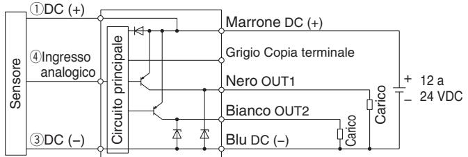
**-RT: PNP (2 uscite) + Uscita analogica in tensione
