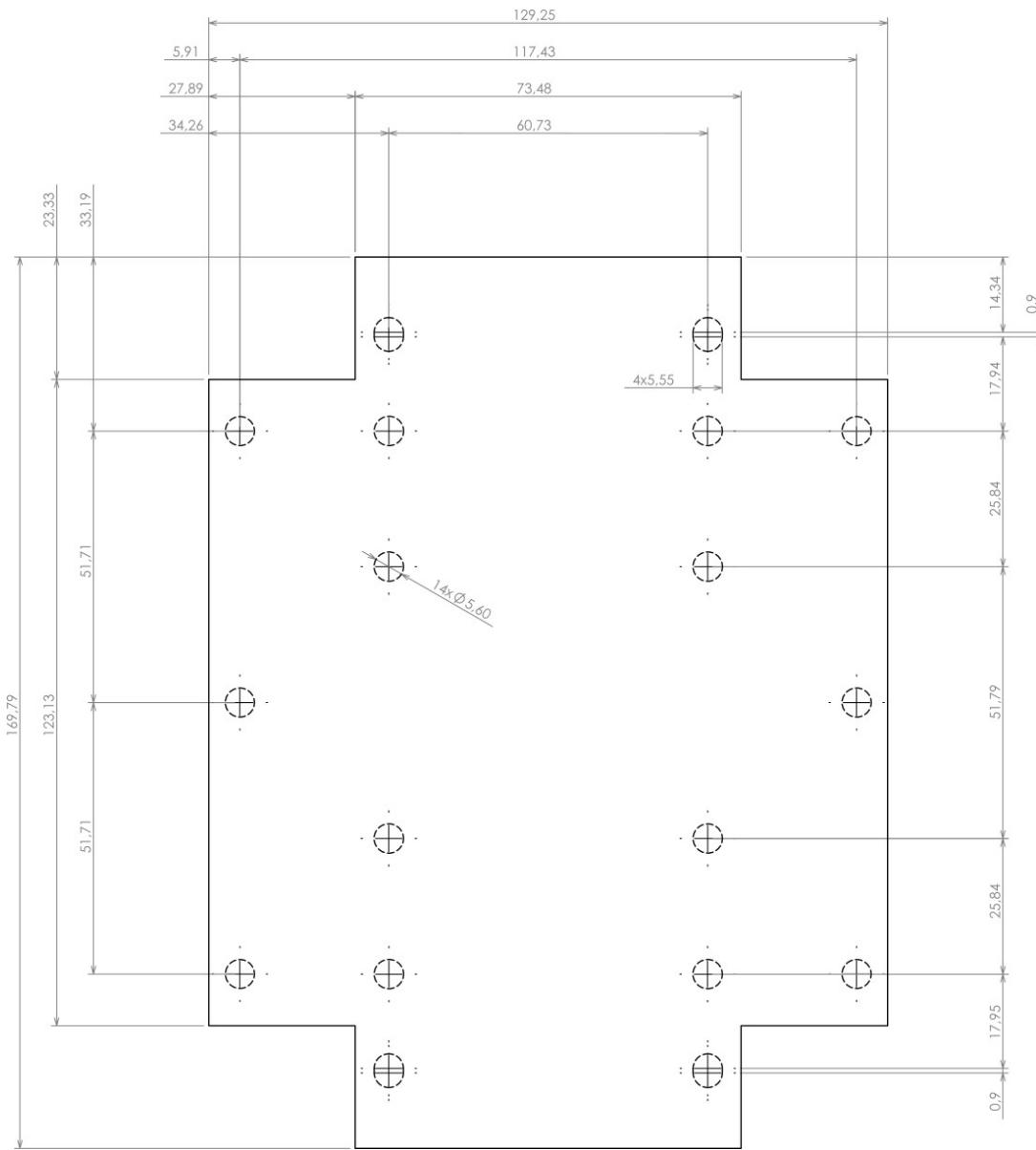
La ligne en pointillés indique le contour du bossage de montage sous la carte de circuit imprimé
