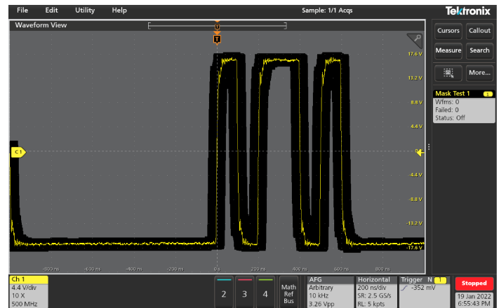
Prueba de máscara de límite basada en la señal de referencia dorada
