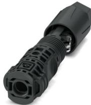
连接器，产品范围: SUNCLIX，颜色: 黑色，位数: 1, 最小导线横截面: 6 mm<sup>2</sup>, 最大导线横截面: 16 mm<sup>2</sup>, 额定电压: 1500 V DC, 额定电流: 60 A, 连接方法: 弹簧, 触点类型: 针式插头, 最小电缆直径: 5.5 mm, 最大电缆直径: 10 mm
