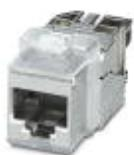
Isolant femelle RJ45, type: RJ45, indice de protection: IP20, nombre de pôles: 8, 10 Gbit/s, CAT6<sub>A</sub>, matériau: Zinc coulé sous pression, type de raccordement: Raccordement IDC, section raccordable: AWG 26- 22, Exécution keystone uniquement utilisable avec un cadre IP20 ou une intégration directe sur la paroi du boîtier
