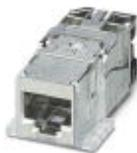
Isolant femelle RJ45, type: RJ45, indice de protection: IP20, nombre de pôles: 8, 10 Gbit/s, CAT6<sub>A</sub>, matériau: Zinc coulé sous pression, type de raccordement: Raccordement IDC, section raccordable: AWG 26- 22, Exécution Freenet pour une utilisation avec des cadres IP67 et des blocs de prise
