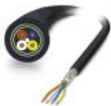
Câble de réseau, PROFINET CAT5 (100 Mbit/s), 4-pôles, PE-X exempt d'halogène, noir RAL 9005, blindé, extrémité libre, sur extrémité libre, longueur de câble: Longueur au choix (0,5 ... 400 m), pour application ferroviaires
