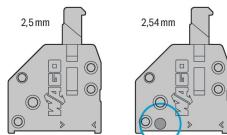
Une cavité sur la face arrière de la borne
