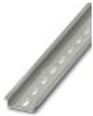
DINレール、取付け穴あり、標準プロファイル、幅: 35 mm、高さ: 7.5 mm、EN 60715準拠、部材: スチール、亜鉛メッキ加工され不動態化処理、長さ: 2000 mm、色: 銀
