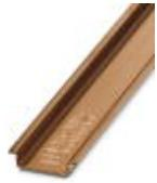
DINレール、取付け穴なし、標準プロファイル、幅: 35 mm、高さ: 7.5 mm、EN 60715準拠、部材: 銅、コーティングなし、長さ: 2000 mm、色: 銀
