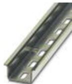
DINレール、取付け穴あり、標準プロファイル、幅: 35 mm、高さ: 15 mm、EN 60715に類似、部材: スチール、亜鉛メッキ加工され不動態化処理、長さ: 2000 mm、色: 銀
