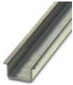
DINレール、取付け穴なし、標準プロファイル、幅: 35 mm、高さ: 15 mm、EN 60715に類似、部材: スチール、亜鉛メッキ加工され不動態化処理、長さ: 2000 mm、色: 銀
