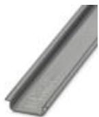
DINレール、取付け穴なし、標準プロファイル、幅: 35 mm、高さ: 7.5 mm、EN 60715準拠、部材: 高品質スチール V2A、コーティングなし、長さ: 2000 mm、色: 銀
