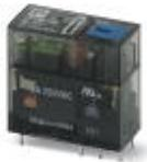
プラグインミニチュアリレー、硬質金メッキのマルチレイヤコンタクトを接続、2 c接点、テストボタン、メカニカルスイッチで位置表示、状態LED、フリーホールダイオード、極性A1+、A2-、入力電圧DC 24 V
