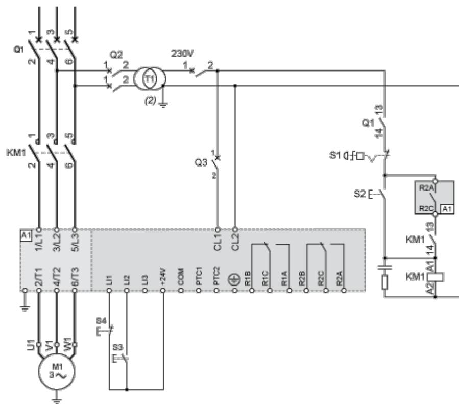
230 Vac 控制，逻辑输入 (LI) 24 Vdc , 2 线控制，自由停车
