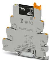
PLC-INTERFACE für Eingabefunktionen bei PLC logic, mit Push-in-Anschluss und steckbarem Miniatur-Solid-State-Relais, zur Montage auf Tragschiene, 1 Schließer, Eingang: 24 V DC
