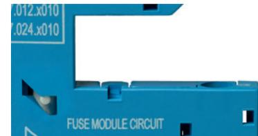
3. Pour rétablir le circuit de sortie, il est nécessaire de remettre le module fusible (avec un fusible fonctionnant) ou alors, il faut remettre l'ergot indicateur blanc dans la position 0 en appliquant une légère pression en direction de la flèche.
