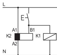
• Possibilité de commander, avec un même contact, le signal de commande sur la borne B1 et éventuellement une charge en parallèle : relais, télérupteur, etc...
