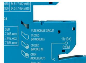
1. Lorsque le module fusible est inséré, après avoir retiré le bouchon, le fusible est en série électriquement avec la borne de sortie de l'interface relais (11 pour les versions EMR, 13 pour les versions SSR, 15 pour le timer EMR, 15+ pour le timer SSR). Dans cet état, l'ergot indicateur blanc est dans la position ci-dessous.
