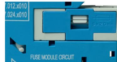
2. Si le module fusible est extrait (par exemple, lorsque le fusible est fondu), le circuit de sortie est verrouillé en position ouverte, correspondant à un état "sécurité". L'ergot blanc est alors dans la position ci-dessous.
