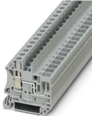
直通式接线端子，标称工作电压: 1000 V，额定电流: 41 A，连接量: 2，接线方式: 螺钉/插拔式连接，额定接线容量: 6 mm<sup>2</sup>，横截面: 0.2 mm<sup>2</sup> - 10 mm<sup>2</sup>，安装方式: NS 35/7,5, NS 35/15，颜色: 灰色
