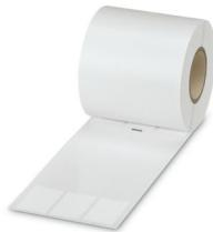
Wire-Wrap标签，盘卷，白色，未标记，适用的打印机：THERMOMARK E.300 (D)/600 (D)，THERMOMARK ROLL 2.0，THERMOMARK ROLL，THERMOMARK ROLL X1，THERMOMARK ROLLMASTER 300/600，THERMOMARK X1.2，电缆直径范围：12.1 ... 36.4 mm，安装方式：背胶固定，电缆直径：≤ 36.4 mm，标签数：500，文本框高度：38.1 mm，文本框宽度：25.4 mm
