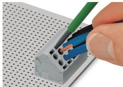
Connexion du conducteur souple et déconnection du conducteur – Ouverture du point de serrage avec outil de manipulation (Largeur de la lame 3,5 mm).
